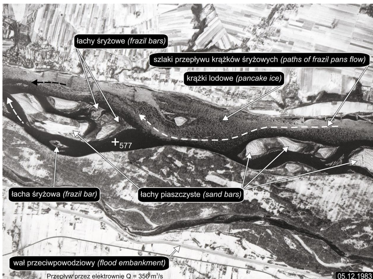
Ryc.3. Rozwój zjawisk lodowych na nieuregulowanym odcinku Wisły w okresie powstawania pokrywy lodowej
