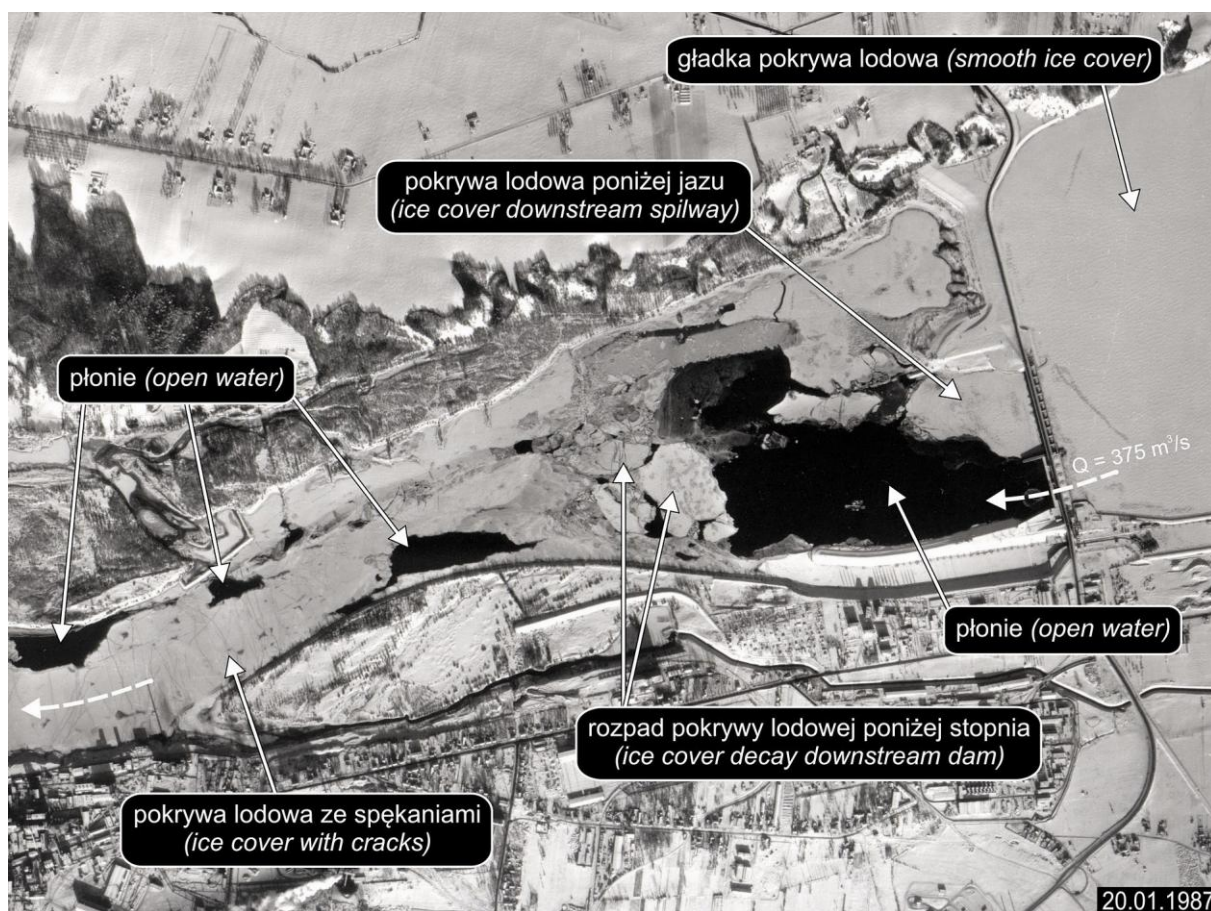
Ryc. 2. Zjawiska lodowe poniżej st. w. „Włocławek”
