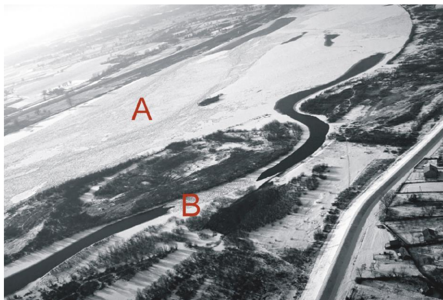
Ryc. 2. W przypadku znacznego wypełnienia głównego koryta lodem /A/, nurt bardzo często przerywa się do bocznej odnogi /B/
